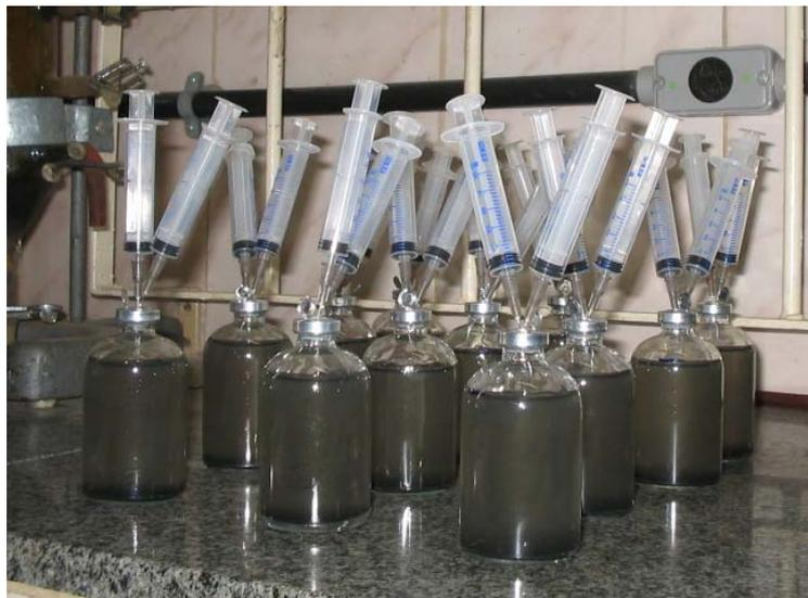
**Figura 3. 10** - Frascos de reação do teste de AME
