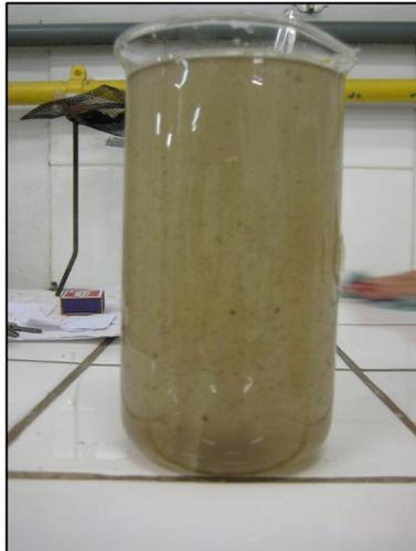
**Figura 45: Recipiente contendo a massa líquida após a sonificação**
