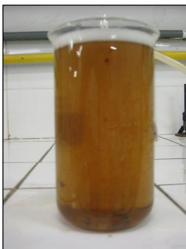
**Figura 47: Recipiente contendo a massa líquida após sonificação**
