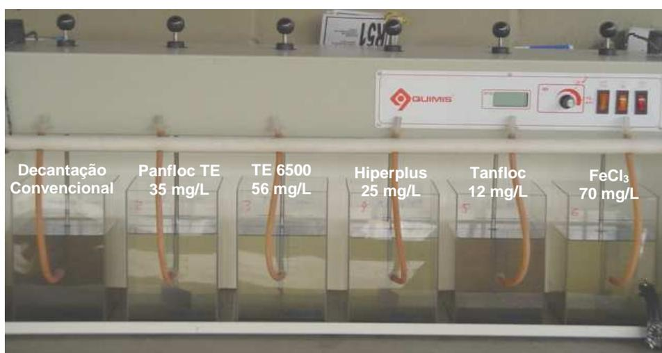
**Figura 5.2:** Ensaio de *Jar Test* após 20 minutos de decantação
