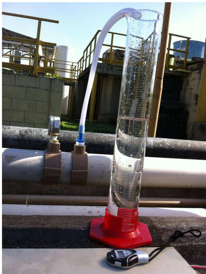
Figura 66: Aparato desenvolvido para captação e medição da água perdida pelos furos.
