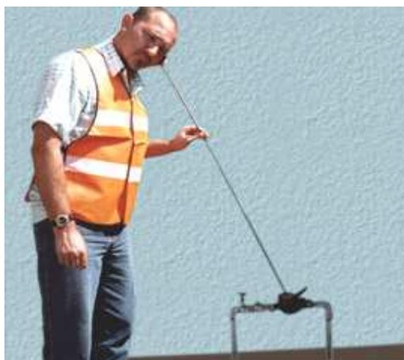
Figura 15: Haste de Escuta Mecânica.
