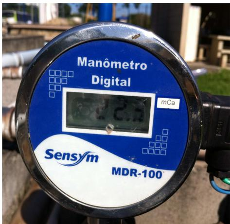
Figura 60: Manômetro digital instalado a montante e a jusante do sistema.
