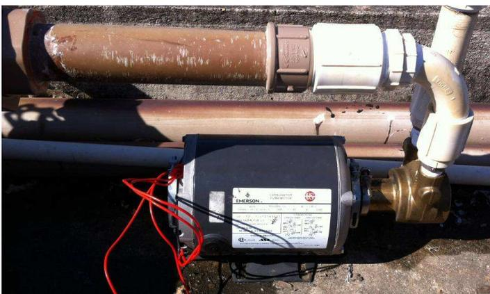
Figura 62: Sistema de pressurização PROCON série 3 utilizado a montante do aparato experimental, com destaque para a bomba pressurizadora.
